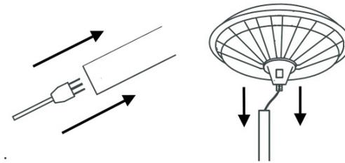
Paso 5: Insertar el cabezal de la estufa en el tubo y fijar en posición usando los tornillos de 4\*8 mm
