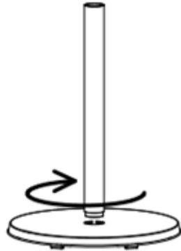
Paso 2: Conectar el mediotubo con el tubo inferior atornillándolos juntos.
