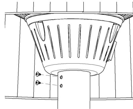
Paso 6: Fije el cable de alimentación en la base utilizando los 4 tornillos M4.
