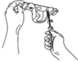
1. Fije la placa de montaje a una viga del techo con dos tornillos, arandelas elásticas y arandelas planas. Asegúrese de que el soporte de la placa de montaje debe ser capaz de sostener de forma segura el peso móvil del ventilador.
