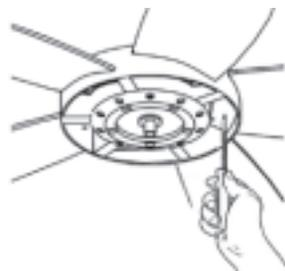
8. Fije el conjunto de aspas al motor con los tornillos y las arandelas elásticas ya fijadas al motor.
