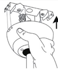
6. Levante la cubierta hasta su lugar sobre la placa de montaje. Asegúrese de no atrapar cables.
