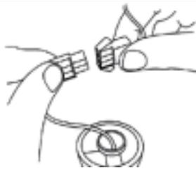
4. Conecte el cable interno al cuerpo del ventilador juntando los dos conectores macho/hembra de plástico hastahacer click firmemente juntos.
