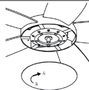
9. Inserte la tapa decorativa, girando hacia la derecha, sobre el motor de rotación.
