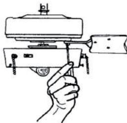
7. Instale los juegos de aspas del ventilador en el motor apretando los tornillos y las arandelas elásticas.
