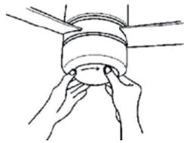
11. Coloque la pantalla usando los tres tornillos de fijación del kit de luz. Asegúrese de no atrapar los cables.
