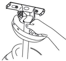
2. Cuelgue el conjunto del ventilador en la placa de montaje. La placa de montaje tiene un terminal en él; este debe estar alineado con la ranura correspondiente en la junta de la articulación del ventilador.
