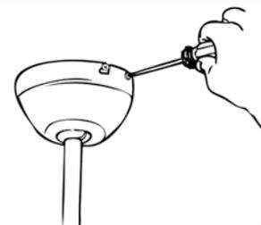
6. Inserte los otros dos tornillos de fijación y las arandelas. Apriete todos los tornillos, asegúrese de que la cubierta está segura y que no haya atrapado ningún cable. Asegúrese de que la ranura de la suspensión de bolas de aleación de zinc encaja en el pasador guía de la cubierta superior.
