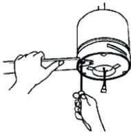
7. Fije las aspas al motor con los tornillos y las arandelas elásticas ya fijadas al motor.
