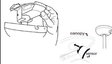
3. Inserte el receptor del control remoto entre el soporte y la articulación. Coloque el sensor (el receptor del mando a distancia) en su agujero en la cubierta (canopy).
