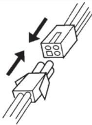
4. Conecte el cable interno al cuerpo del ventilador juntando los dos conectores macho/hembra de plástico hasta hacer click firmemente juntos.
