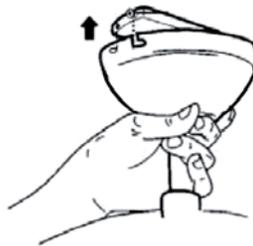
5. Sujete la cubierta al soporte alineando los orificios laterales del dosel con los orificios laterales del soporte. Levante el ventilador hasta que los tornillos alcancen la parte inferior de las ranuras y luego gire la cubierta en sentido contrario a las agujas del reloj hasta que los tornillos entren en las rebajas de las ranuras.
