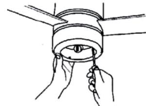
9. Coloque el soporte de montaje de luz utilizando los tres tornillos de fijación del kit de luz y las arandelas de estrella. Asegúrese de no atrapar cables.
