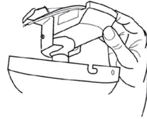
3. Inserte el receptor del control remoto entre el soporte y la articulación. Coloque el sensor (el receptor del mando a distancia) en su agujero en la cubierta (canopy).
