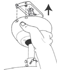
6. Levante la cubierta hasta su lugar sobre la placa de montaje. Asegúrese de no atrapar cables.
