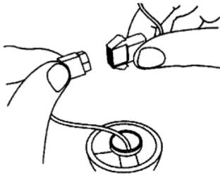
4. Conecte el cable interno al cuerpo del ventilador juntando los dos conectores macho/hembra de plástico hasta hacer click firmemente juntos.
