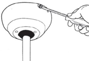
7. Deslice las ranuras en la cubierta hasta los tornillos en cada extremo de la placa de montaje, asegúrelo con los cuatro tornillos, arandelas elásticas y arandelas de estrella suministradas.
