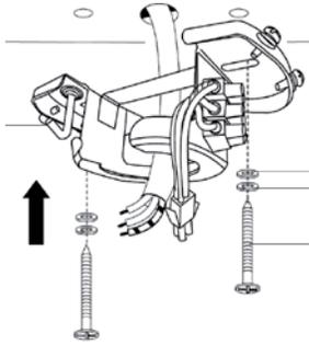
1. Fije la placa de montaje a una viga del techo con dos tornillos, arandelas elásticas y arandelas planas. Asegúrese de que el soporte de la placa de montaje debe ser capaz de sostener de forma segura el peso móvil del ventilador.
