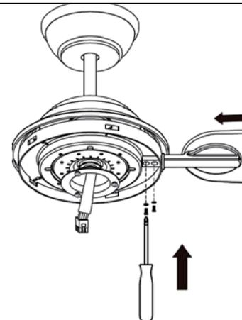
9. Instale los juegos de aspas del ventilador en el motor apretando los tornillos y las arandelas elásticas.
