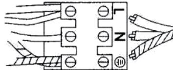
5. Conectar los cables de la red eléctrica, conectada a tierra, al bloque de terminales.
