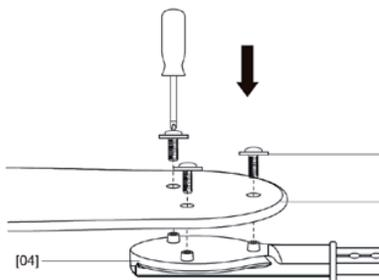
8. Ensamble los soportes de las aspas a cada aspa con tres tornillos, arandelas elásticas, arandelas planas y tuercas. Asegúrese de que los tres tornillos aprieten cada aspa.
